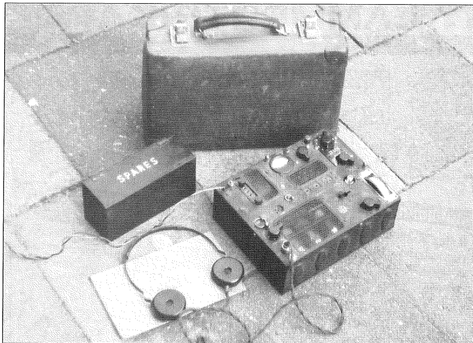
De 'portable wireless set type A. Mk. III' zoals de spionage zend-ontvanger officieel voluit heet. De buiten afmetingen van de bruine leren koffer zijn 325 X 205 X 115 mm. Het gewicht van de set in de koffer is minder dan 4 kg.
