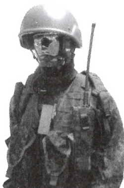
Рисунок 1.4 – Размещение радиостанции с антенной АШ-136/520-П (приемопередатчик на груди)
