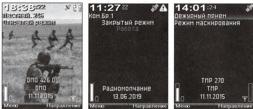
Рисунок 3.10 - Внешний вид «Основного экрана» радиостанции в открытом режиме, закрытом режиме и режиме ТМР
