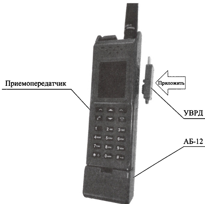
Рисунок 2.7 – Приемопередатчик с УВРД
