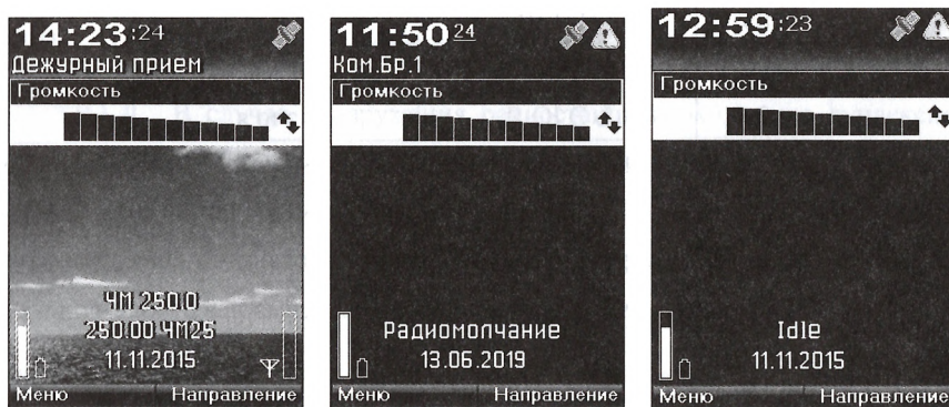
Рисунок 3.14 - Вид экрана радиостанции при регулировке уровня громкости в открытом, закрытом режимах и режиме TMR
